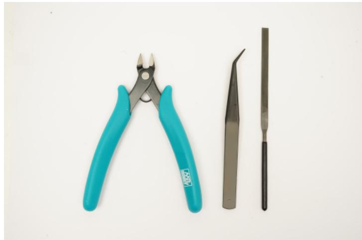
Werkzeugset: Zange, abgewinkelte Pinzette und Feile für Kunststoffmodellbausätze
