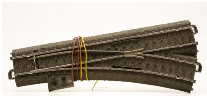
C-Gleis Weiche rechts, mit Antrieb und Decoder
