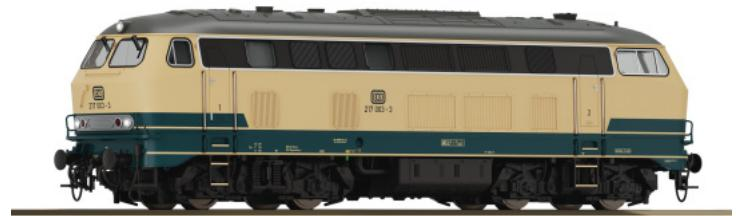
Die Baureihe 217 der Deutschen Bundesbahn (DB) war eine leistungsstärkere Weiterentwicklung der bekannten V-160-Familie und stellte eine technische Zwischenlösung dar, um einen konkreten betrieblichen Bedarf zu decken: den Einsatz schwerer Wendezüge mit elektrischer Zugheizung auf nicht elektrifizierten Strecken.
