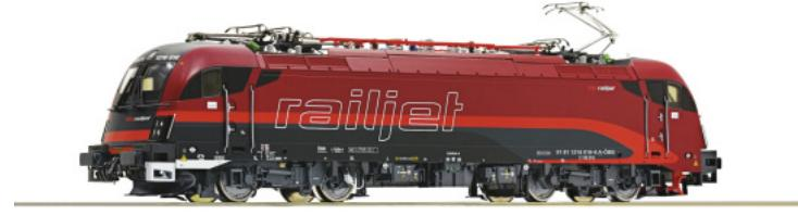
Die Elektrolokomotiven der Reihe 1216 (Taurus 3), sind Mehrsystem-Drehstrom-Universallokomotiven, die auf der Technik der Siemens-EuroSprinter-Typenfamilie basieren. Das Äußere und die Schnellfahrdrehgestelle wurden von den ersten beiden Taurus-Generationen übernommen, jedoch mit einigen Detailänderungen.
