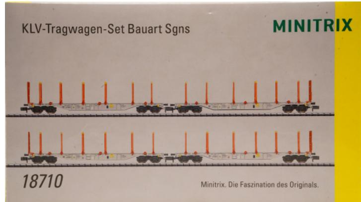
4 vierachsige KLV-Tragwagen der Bauart Sgns 121 in seidengrauer Grundfarbgebung. Privatwagen der AAE Cargo AG, vermietet an Hector Rail AB, SE-Danderyd. Mit Holzladegestellen ExTe SR12, Stützschwellen und Stirnwandgitter, zum Transport von Stammholz
