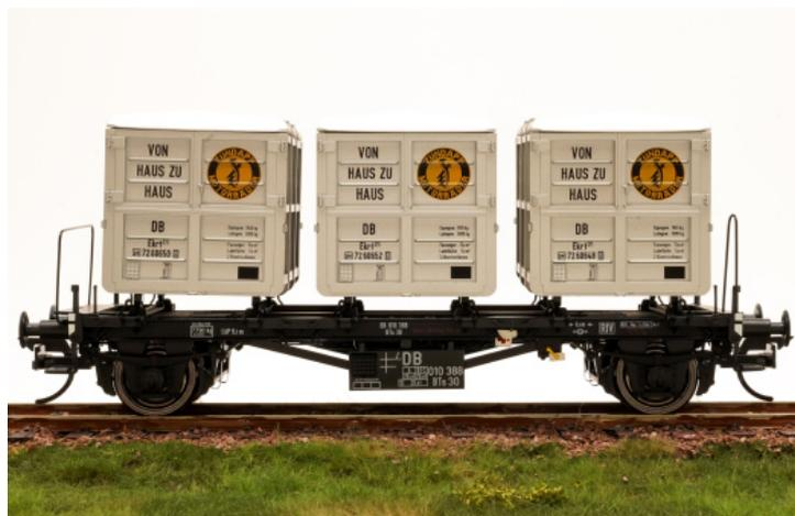
Modell: Filigraner, durchbrochener Rahmen aus Zinkdruckguss; feinste Bedruckung und Lackierung; extra angesetzter Achslagerdeckel; Räder aus Metall; Räder auch innen profiliert
