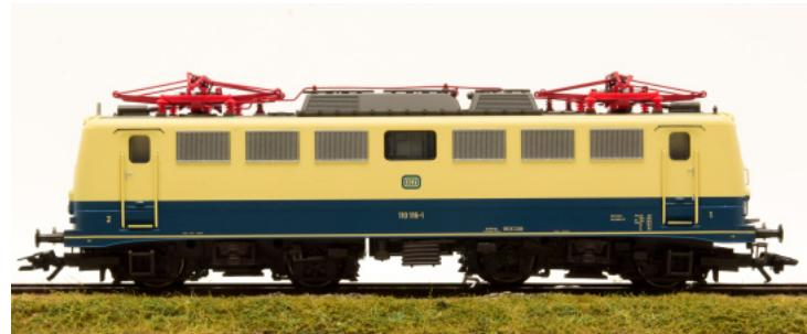
Elektrolok Baureihe 110.1 der Deutschen Bundesbahn (DB). Mit drei Lampen am Lokende 1 und fünf Lampen am Lokende 2. Mit „Klatte“-Lüftergitter und einteilige, abgerundete Maschinenraumfenster. Ohne umlaufende Regenrinne. Ohne Schürzen und Pufferverkleidungen. Farbgebung in Ozeanblau/Elfenbein.
