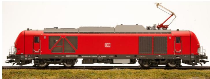
Zweikraftlokomotive BR 249 (Vectron Dual Mode light) der DB Cargo AG.
