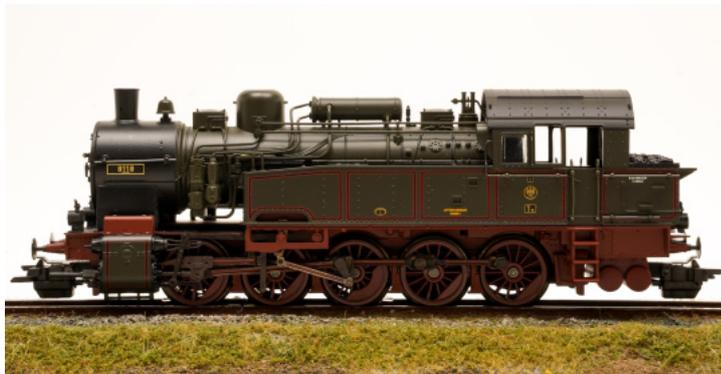
Tender-Dampflokomotive T16 der KPEV in braungrüne Grundfarbgebung, mit Läutewerk und Vorwärmer auf dem Kesselscheitel sowie Stangenpuffer
