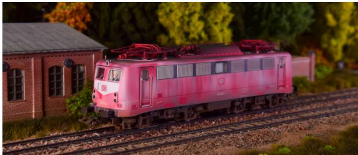
Elektrolokomotive Baureihe 140 der Deutschen Bahn AG (DB AG). Mit „Klatte“-Lüftergitter und einteiligem, abgerundetem Maschinenraumbenfenster. Orientrote Grundfarbgebung.
