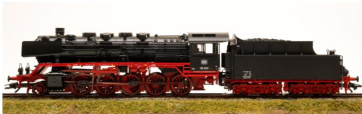
Güterzug-Dampflokomotive Baureihe 50 der Deutschen Bundesbahn (DB), mit Kohlen-Schlepptender als Einheits-Kastentender 2'2'T26 in der Ursprungsform. Mit Witte-Windleitblechen, Regelführerhaus, langem Umlauf vorne zur Rauchkammer schräg abfallend, DB-Reflexglaslampen und einseitigem Indusi
