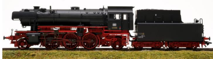
Personenzug-Dampflokomotive Baureihe 23 der Deutschen Bundesbahn (DB), Bauart 1'C1'h2. Gebaut ab 1950. Schwarze Ausführung der Kesselspannbänder.
