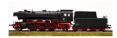
Personenzug-Dampflokomotive Baureihe 23 der Deutschen Bundesbahn (DB), Bauart 1´C1´h2. Gebaut ab 1950. Schwarze Ausführung der Kesselspannbänder.
