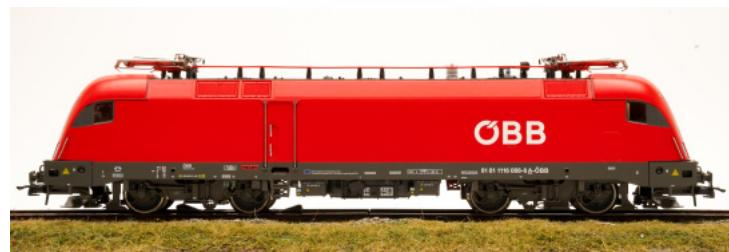
Mit der Indienststellung der ersten „Taurus“-Lokomotive Reihe 1016 im Sommer 1999 begann die rasante Modernisierung der österreichischen E-Lok-Flotte. Von dieser Universallokomotive wurde auch eine Zweisystemausführung für den Wechselstrombetrieb mit 15 kV/16,7 Hz sowie 25 kV/50 Hz beschafft. Bis 2006 wurden 282 Lokomotiven der Reihe 1116 in Dienst gestellt. Sie sind für 230 km/h zugelassen. Die Leistung beträgt 6.400 kW.
