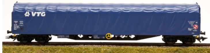
4-achsiger Schiebeplanenwagen Bauart Rilns. Europäische Standardbauart mit 19,90 m Länge. Privatwagen der AAE Cargo, registriert in Deutschland. Violettblaue Grundfarbgebung mit großem VTG-Logo. Betriebszustand ab 2015.
