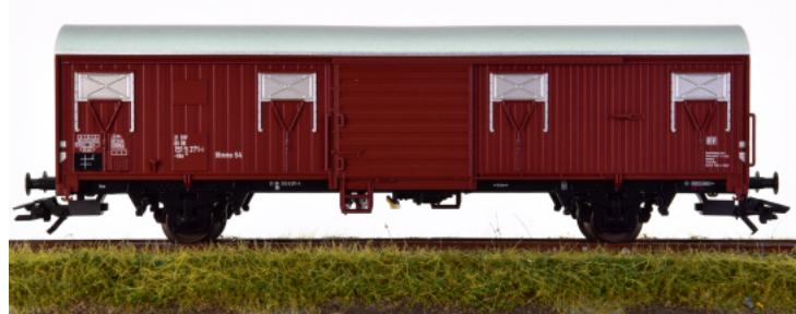
Güterwagen mit Stahlblechwänden in Spundwandform der Bauart Gbs 256 (Glmms 64) der Deutschen Bundesbahn (DB). Ausführung ohne Sprengwerk. Der Wagen ist im Neubauzustand um 1966.
