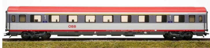
1. Klasse Eurofima-Reisezugwagen Bmz der ÖBB mit typspezifisch gestalteter Unterboden. Fiat Drehgestelle Y0270 S mit Schlinger dampfer und mit Magnetschienenbremse. Eurofima-Wagen modernisiert, nicht druckertüchtigt.
