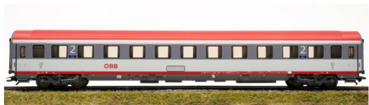
2. Klasse Eurofima-Reisezugwagen Bmz der ÖBB mit typspezifisch gestalteter Unterboden. Fiat Drehgestelle Y0270 S mit Schlinger dampfer und mit Magnetschienenbremse. Eurofima-Wagen modernisiert, nicht druckertüchtigt.
