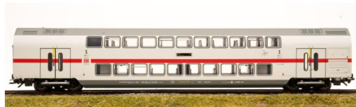
IC2 Doppelstock-Mittelwagen DApza 687.2, 1. Klasse, der Deutschen Bahn AG (DB AG) für den Fernverkehr. Lichtgraue Fernverkehrs-Farbgebung mit verkehrsrotem Zierstreifen, im aktuellen IC-Design. Zuglauf: IC 2045 von Köln nach Dresden Hbf. Wagen-Ordnungsnummer 5. Betriebszustand 2020.
