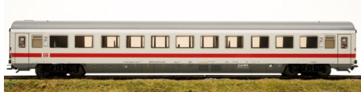
2. Klasse Abteilwagen Bvmz 185.5 der Deutschen Bahn AG (DB AG) für den Fernverkehr. Lichtgraue Fernverkehrs-Farbgebung mit verkehrsrotem Zierstreifen. Wagenlauf: IC 2013 von Dortmund nach Oberstdorf. Wagen-Ordnungsnummer 10.
