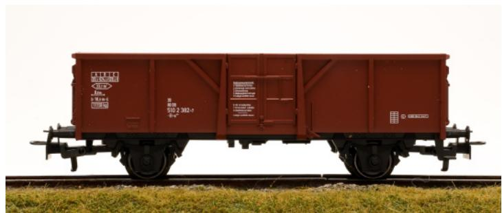
Diese Mittenselbstentlader waren eine ganz raffinierte Bauform unter den Güterwagen. Beide Seiten des Wagens konnten angehoben werden und halfen so bei einer einfachen und schnellen Entladung des Schüttguts.
