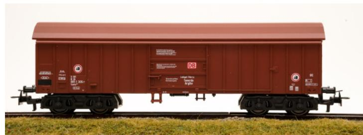
Die Schwenkdachwagen sind die Spezialisten für schwere und sperrige Güter. Diese vierachsigen Transporthelden verfügen über ein bewegliches Dach. In der Mitte getrennt, konnte das Dach zu beiden Längsseiten ausschwenken.
