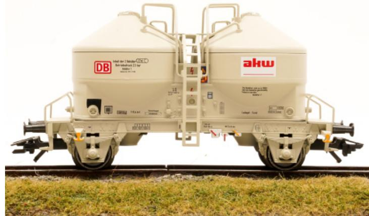
Zweiachsiger Staubsilowagen der Bauart Ucs 908 der Deutschen Bundesbahn (DB). Mit Werbeaufschrift der akw Amberger Kaolinwerke GmbH, Hirschau. Betriebszustand um 2008.
