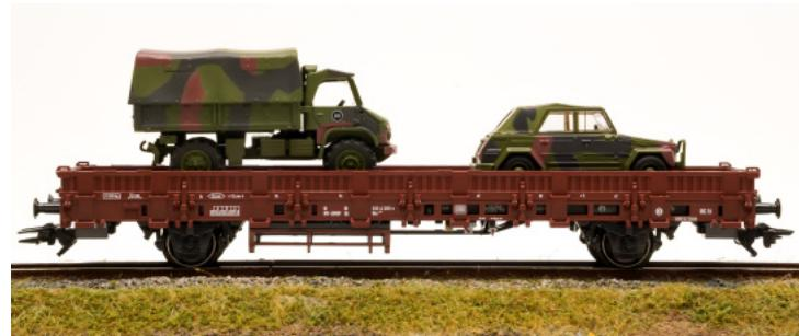
Rungenwagen Bauart Kbs 443 der Deutschen Bundesbahn (DB). Ausführung ohne Handbremsbühne. Eingesetzt zum Transport von Militärfahrzeugen.
