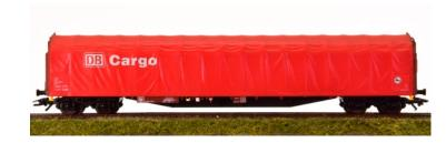
Bauart Rils 652 der Deutschen Bahn AG (DB Cargo). Europäische Standardbauart mit 19,90 m Länge. Ausführung mit eckigen Puffern
