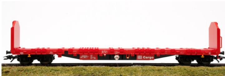
Bauart Roos 639 der Deutschen Bahn AG (DB Cargo). Europäische Standardbauart mit 19,90 m Länge. Ausführung mit festen Stirnwänden und Rungen
