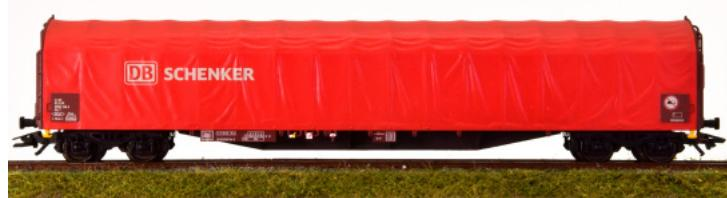
Vierachsiger Schiebeplanenwagen Bauart Rils 652 der Deutschen Bahn AG (DB AG), Gütersparte DB Schenker. Verkehrsrote Grundfarbgebung. Europäische Standardbauart mit 19,90 m Länge. Ausführung mit eckigen Puffern und ohne Feststellbremse. Betriebszustand um 2017.
