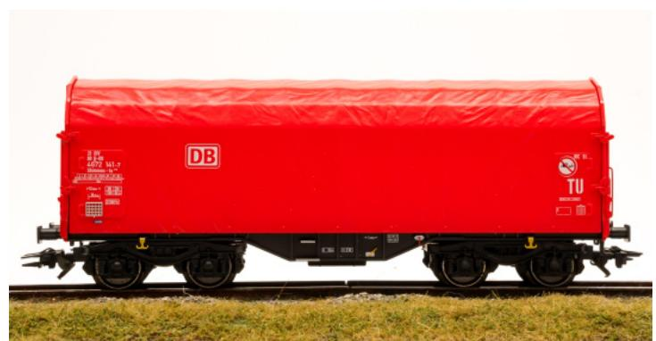
Kurzer, vierachsiger Schiebeplanenwagen Bauart Shimmns-tu 718 der Deutschen Bahn AG. Verkehrsrote Grundfarbgebung. Betriebszustand ab 2017.
