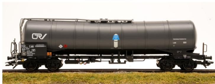
Vierachsiger 95 m<sup>3</sup> Kesselwagen Bauart Zans mit unisolierterem Kessel und stirnseitigem Aufstieg. Privatwagen der On Rail GmbH (ORV), registriert in Deutschland. Betriebszustand 2018.
