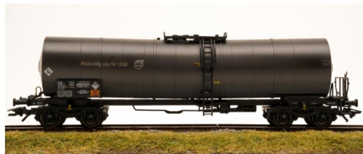
Ein vierachsiger Spezialwagen für chemische Produkte Bauart Zaces, eingestellt bei der Green Cargo (GC), Privatwagen der LKAB. Bauart mit isoliertem Knickkessel. Zustand um 2015.
