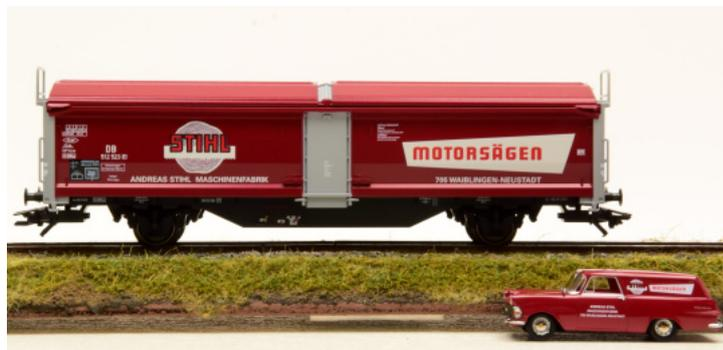
Zweiachsiger Schiebedach-/Schiebewandwagen Bauart Tbes-t-66, mit längsseitiger Werbebeschriftung. Ausführung mit gewölbten Schiebewänden. Braunrote Schiebewände und Schiebedach. Privatwagen der Firma Andreas Stihl Maschinenfabrik, Waiblingen-Neustadt, eingestellt bei der Deutschen Bundesbahn (DB). 1 PKW Opel Rekord P2 Caravan als Firmenwagen der Firma Stihl.
