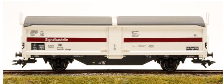
Zweiachsiger Schiebedach-/Schiebewandwagen Bauart Tbes-t-66, mit längsseitiger Werbebeschriftung Signalbauteile. Ausführung mit gewölbten Schiebewänden.
