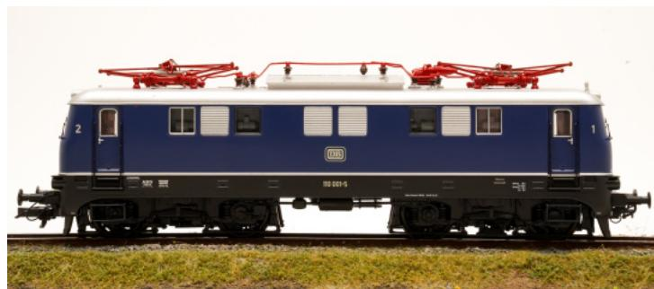
Elektrolokomotive Baureihe 110 der Deutschen Bundesbahn (DB). Voserienlok mit Lok-Nr.: 110 001-5; Einsatz hauptsächlich vor Nahverkehrszügen oder Güterzügen.
