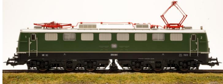
Elektrolokomotive Baureihe E 50 der DB, Epoche III, neue Dachform mit Topfanten, Ausführung in grüner Farbgebung.
