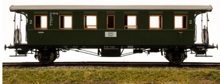
Angesetzte Schilder, Griffstangen und Trittstufen; extra angesetzte Bremsrücksteller aus Ätzblech; mehrteilige Bremsanlage mit Bremsbacken in Radebene.
