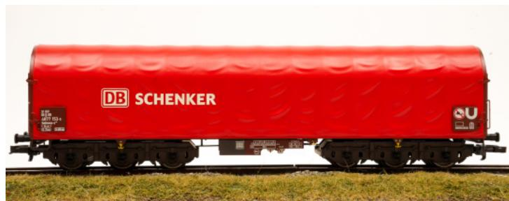
6-achsiger Transportwagen für Blechcoils der Bauart Sahimms-u 901 der DB Schenker mit Schiebeplanenhaube und GPS-Antenne.
