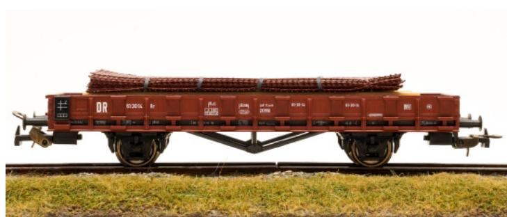
Rungenwagen mit Baustahlmatten . Die Rungen bestehen aus Metall.
