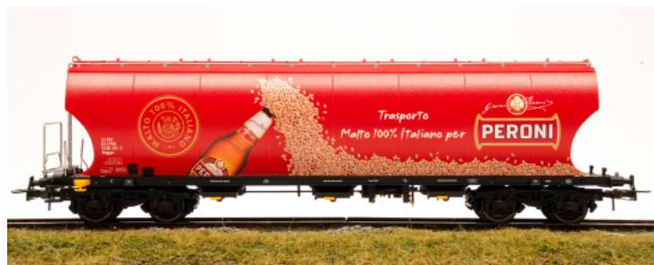
Der Getreidesilowagen ist speziell für den Transport von Malz konzipiert, einem Hauptbestandteil für die Bierproduktion. Die Beschriftung Trasporto Malto 100% Italiano per PERONI unterstreicht die Herkunft des Produkts und die Verbindung zur bekannten italienischen Brauerei Peroni. Diese Silowagen sind für den sicheren und effizienten Transport von empfindlichen Schüttgütern wie Malz ausgelegt und spiegeln die Bedeutung des Schienengefahrs für die Lebensmittelindustrie wider.
