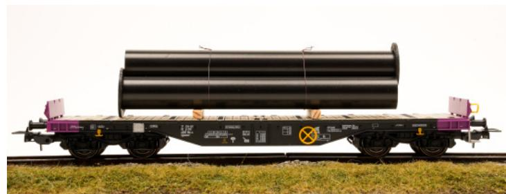
Flachwagen Sgmmns der ERR (European Rail Rent GmbH), mit Großrohr Beladung auf Holzlagerbalken
