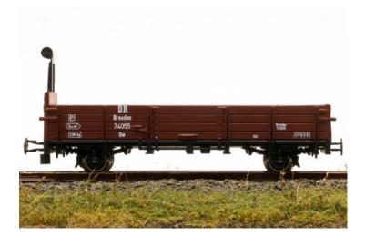
Epoche III Betruebsnummer 7.4055 Bauart Ow Trichterkupplung LüP ca. 76 mm Zurüstteile liegen bei
