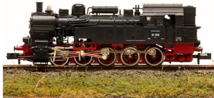
Tenderlokomotive Baureihe 94.5 der DRG, Führerhaus mit Tonnendach
