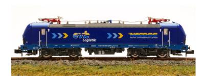
Mehrsystem-Elektrolok Siemens BR 192 Vectron der EVB - Eisenbahnen und Verkehrsbetriebe Elbe-Weser
