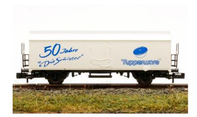
Bauart Ichqrs Kupplungsaufnahme nach NEM 355 Kurzkupplungskinematik LüP ca. 74 mm
