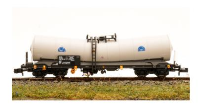
Die Knickkesselwagen des Typs Zafns dienen zum Transport von Kreideschlamm. Um das Entladen des Schlamms zu ermöglichen, ist der Wagen in der Mitte zum Auslassventil hin geneigt. Die Wagen sind seit Mitte der 1980er Jahre im Einsatz und werden von verschiedenen Güterwagen-Einstellern und Bahngesellschaften betrieben. Sie sind vor allem in Deutschland, Frankreich und Großbritannien beheimatet und registriert. Die Wagen sind sowohl fährboottauglich als auch für den Kanaltunnel zugelassen.
