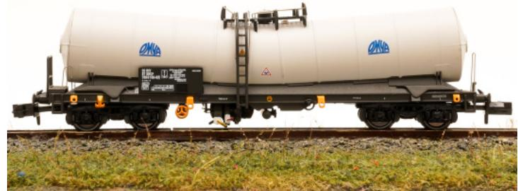
Die Knickkesselwagen des Typs Zafns dienen zum Transport von Kreideschlamm. Um das Entladen des Schlamms zu ermöglichen, ist der Wagen in der Mitte zum Auslassventil hin geneigt. Die Wagen sind seit Mitte der 1980er Jahre im Einsatz und werden von verschiedenen Güterwagen-Einstellern und Bahngesellschaften betrieben. Sie sind vor allem in Deutschland, Frankreich und Großbritannien beheimatet und registriert. Die Wagen sind sowohl fährboottauglich als auch für den Kanaltunnel zugelassen.
