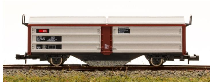
Schiebedach-/Schiebewandwagen als Schienenreinigungswagen Tbis der SBB
