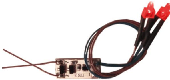
Kleine, einfach einzubauende Bausteine für Führerstände bzw. Schlusslichter sind ebenfalls erhältlich. Diese bestehen aus einer einzelnen warmweißen bzw. zwei roten LED nebst Ansteuerelektronik.
