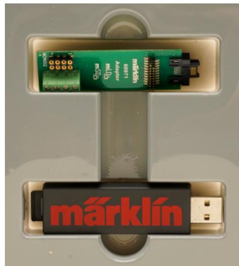
Decoder-Programmer, für Digital-Formate fx, mfx, und DCC
