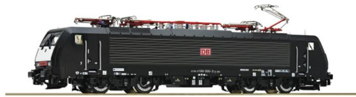
Auf der Erzverkehrsroute Rotterdam Maasvlakte - Dillingen Hütte, wo auch sechsachsige Erzwagen mit automatischer Mittelpufferkupplung eingesetzt werden, fahren seit fast zehn Jahren die vierachsigen Viersystem-Elektrolokomotiven der Baureihe 189, meist in Doppeltraktion. Da in Holland ein anderes Stromsystem genutzt wird hatte man den Wunsch, die schweren Erzzüge ohne Lokwechsel an der deutsch-holländischen Grenze durchfahren zu lassen.
