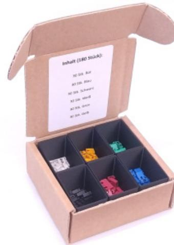
Steckbrücken / Jumper Sortiment, 3A RMS belastbar, 2,54mm Pin-Abstand. Passend für den nux Universal Stromverteiler.
