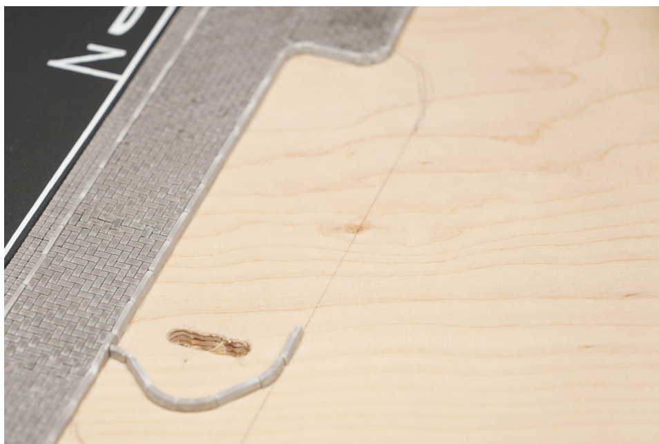
Abbildung 16: Das grob gebohrte Langloch in der Grundplatte, die Ränder sind noch ausgefranst
