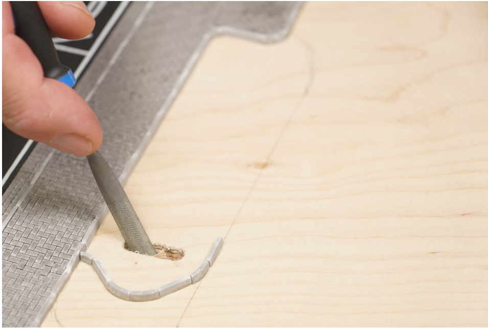
Abbildung 17: Mit einer Flachfeile wird das gebohrte Loch zu einem sauberen Langloch nachgearbeitet
