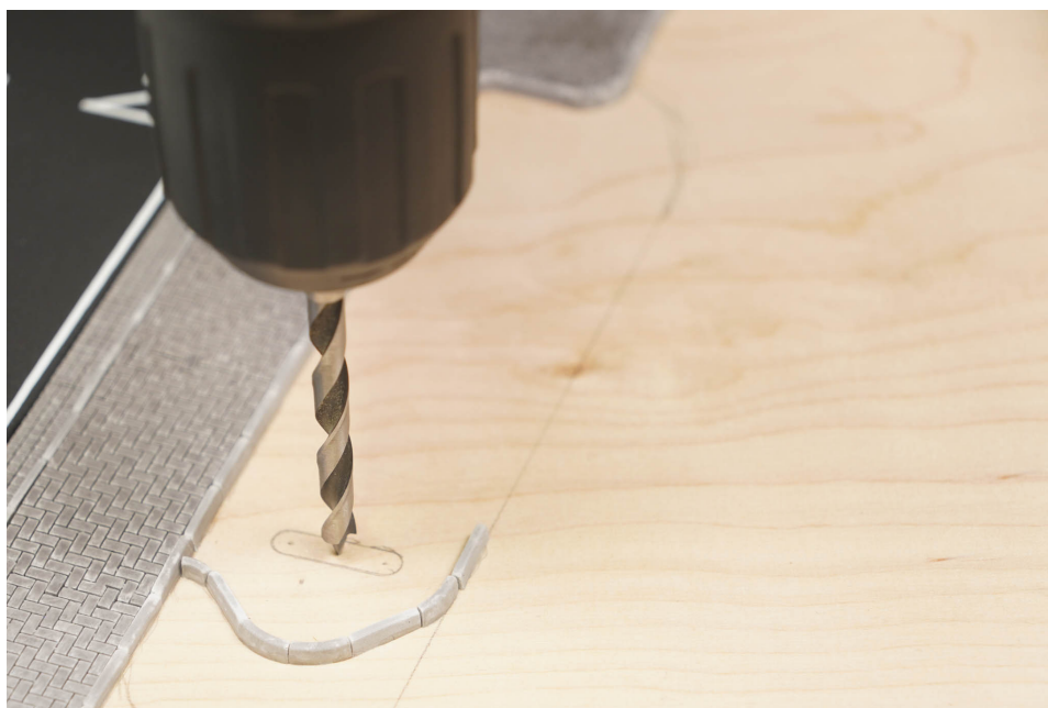
Abbildung 15: Ein 5-mm-Holzbohrer bohrt senkrecht in die angezeichnete Fläche auf der Grundplatte
