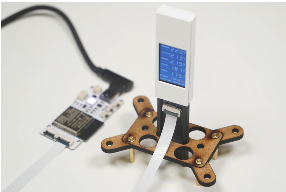
Abbildung 10: Der fertige Ständer mit laufendem Display, daneben der angeschlossene Controller mit Stromkabel
