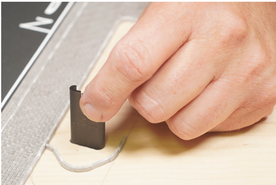
Abbildung 18: Die schwarze Schiene wird von oben in das Langloch gesteckt und probeweise durchgeschoben
