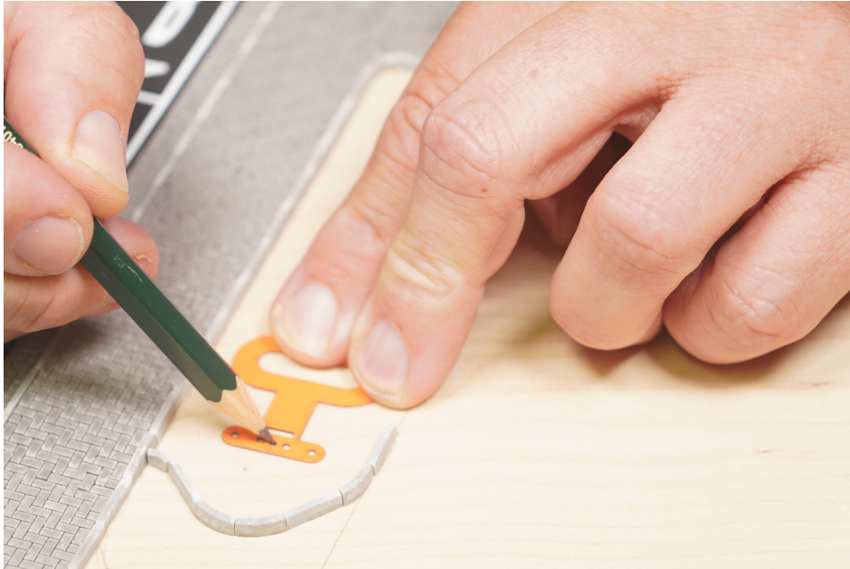
Abbildung 12: Mit einem Bleistift werden durch die kleinen Löcher der Anzeichenhilfe Punkte auf die Platte gezeichnet
