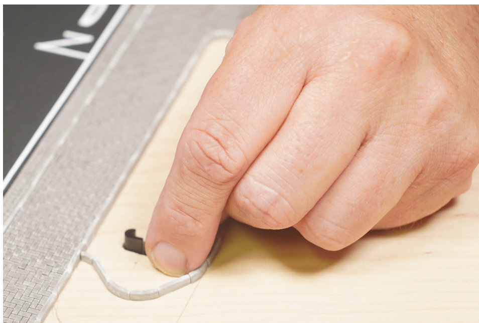
Abbildung 19: Die Schiene ist vollständig durch das Langloch geschoben und schließt bündig mit der Plattenoberfläche ab
