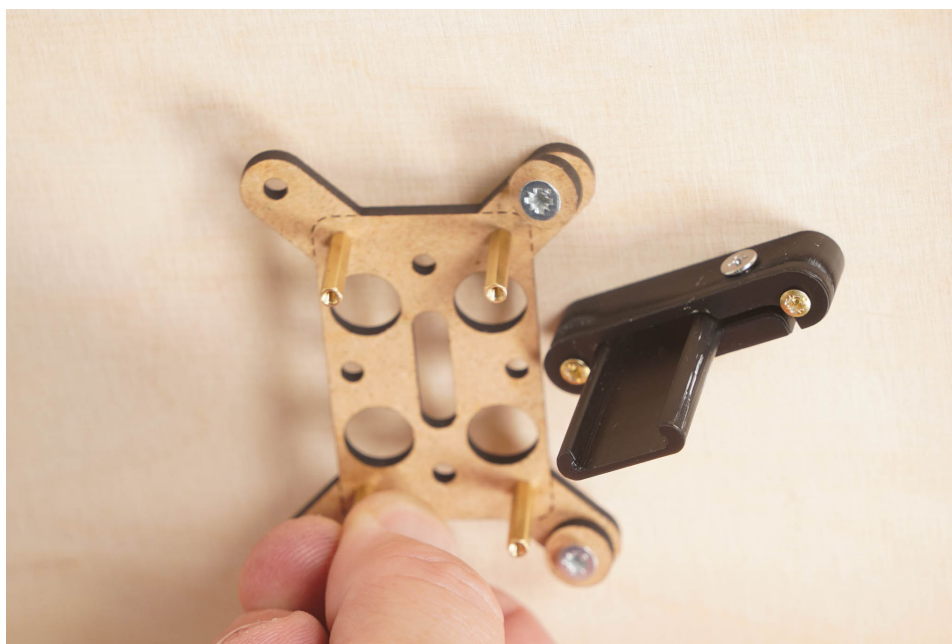
Abbildung 27: Zwei der vier Spanplattenschrauben sind bereits eingedreht und halten den Controller-Halter an der Platte
